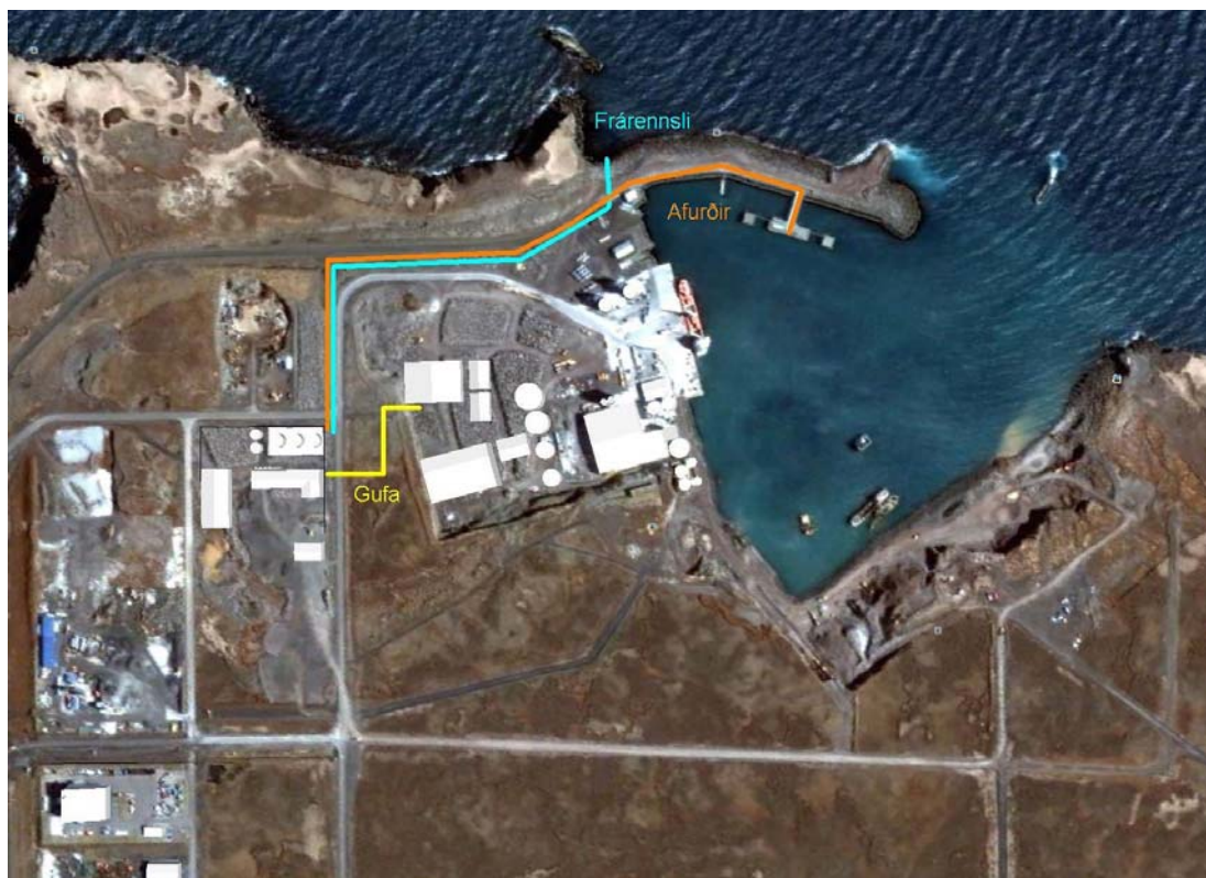
Mynd 12: Lagnaleiðir vegna gufupípu, afurðaleiðslu og kælivatns
